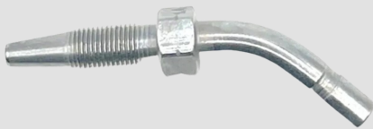
100-057-NUT ; HOSE STUD 45° GROOVED | D 6 | H 24 | L 15 | HOSE Ø 4
