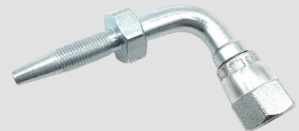
3511-114 HOSE STUD 90° JIC | D JIC 37° 7/16 | H 20,7 | L 25,7 | HOSE Ø 4
