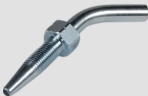
100-057 HOSE STUD 45° D 6 | H 24 | L 15 | HOSE Ø 4
